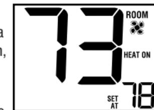
**HEAT ON** (Calefacción encendida) Indica que su sistema de calefacción está funcionando.
